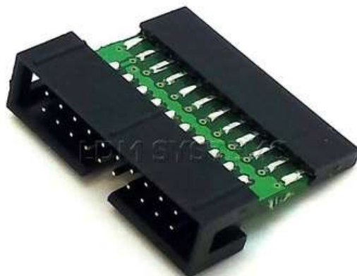
Рисунок 2. Вид переходника JTAG IDC20 в PBS12 для подключения программатора ULINK2
