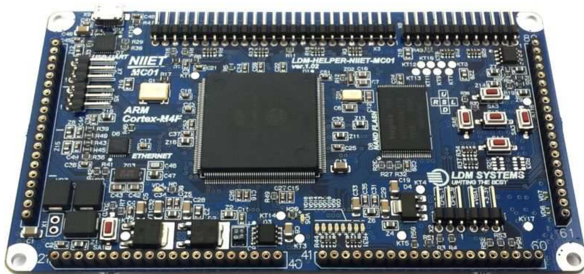
Рисунок 1. Общий вид отладочной платы LDM-HELPER-K1921BK01T в полной комплектации с контроллером в пластиковом корпусе QFP208L
