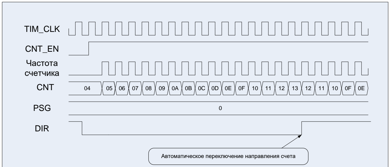
Рисунок 40 – Диаграммы работы таймера, счет вверх/вниз, сначала вверх
