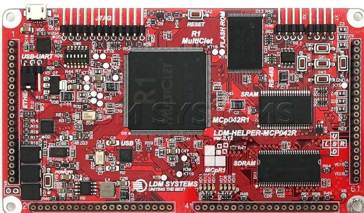
Рисунок 1. Общий вид отладочной платы **LDM-HELPER-MCP042RQ256** в полной комплектации
