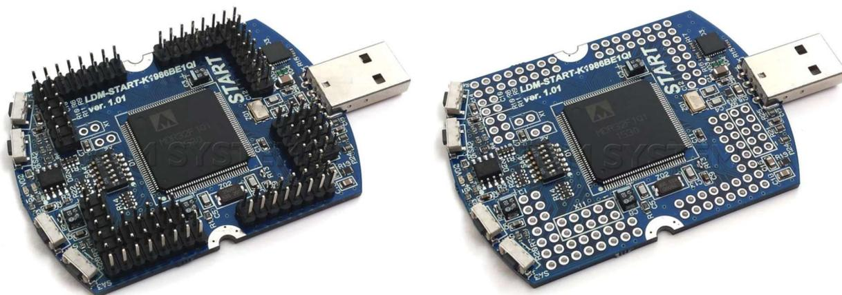
Рисунок 1. Общий вид отладочной платы LDM-START-K1986BE1QI-T (с установленными разъемами) и LDM-START-K1986BE1QI (без разъемов)
