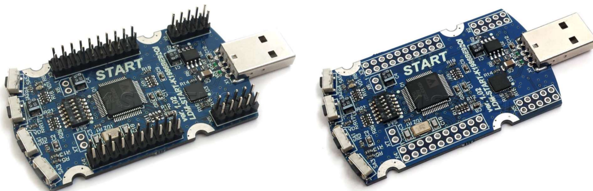
Рисунок 1. Общий вид отладочной платы LDM-START-K1986BE92QI-T (с установленными разъемами) и LDM-START-K1986BE92QI (без разъемов)
